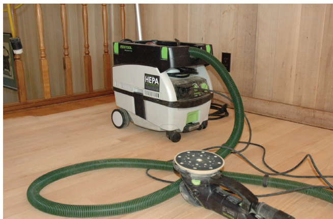
圖片：該磨砂機連接至真空過濾系統以捕獲木屑。
