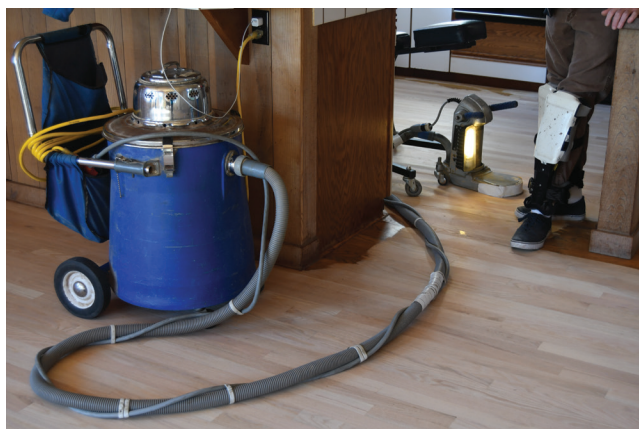
圖片：該落地式磨砂機連接至真空過濾系統以防止木屑進入空氣中。
