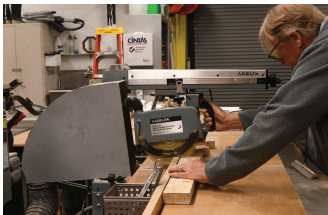
圖片：使用配備局部廢氣通風裝置的旋臂鋸的工作人員。
