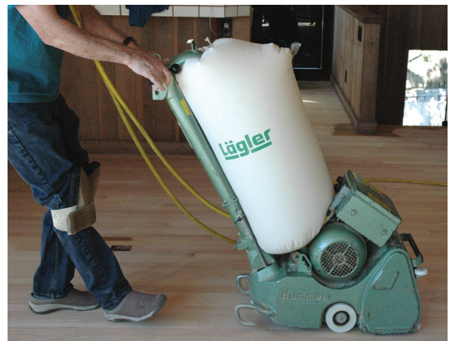
圖片：配備木屑捕獲系統的落地式磨砂機。
