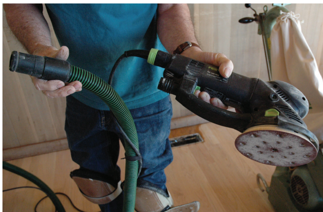
圖片：該磨砂機連接至真空過濾系統以捕獲木屑。
