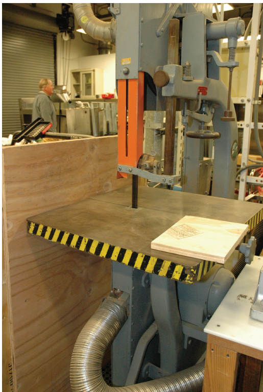
圖片：配備用於捕獲木屑的局部廢氣通風裝置的帶鋸。
