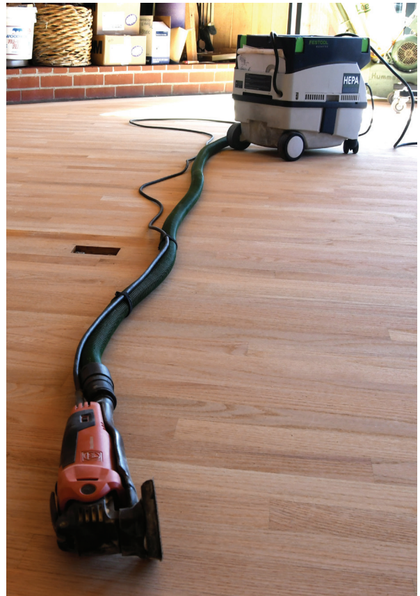
圖片：連接至真空過濾系統的磨砂機。
